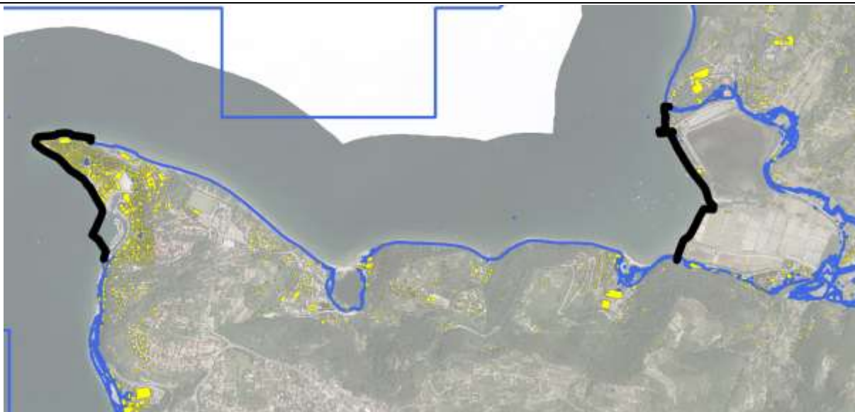
Slika 24: Shematski prikaz možnih ukrepov zaščite pred dvigom srednje gladine morja (občina Piran) – sever - črna linija – zaščita na liniji obstoječe linije morja (modra linija informativno podaja možne dosege gladin dosege gladin po pesimističnem scenariju RCP 8.5 Gn500)
